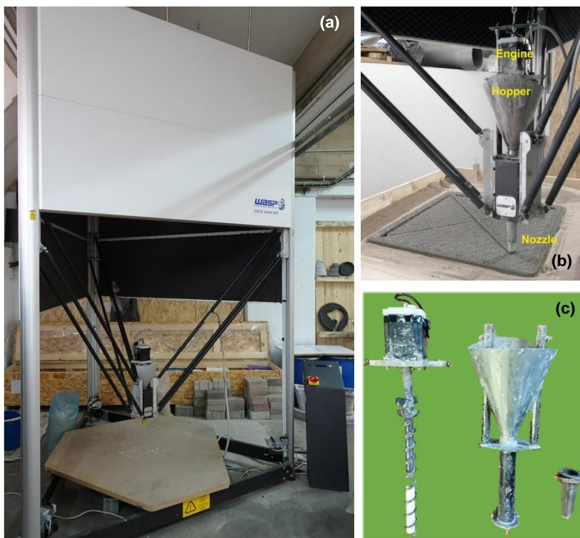
Figura 3-20. (a) Impresora 3D tipo delta. (b) Cabezal de impresión. (c) Piezas del cabezal: motor con tornillo sin fin, tolva y boquilla.
