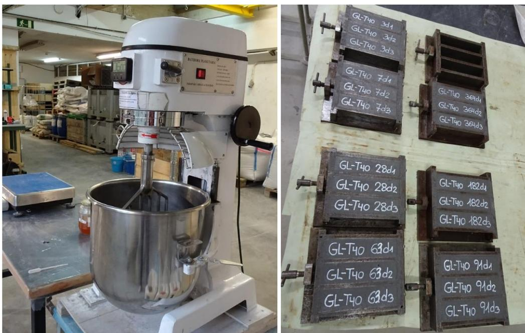
Figura 3-6. Mezcladora planetaria y moldes metálicos para la elaboración de morteros.
