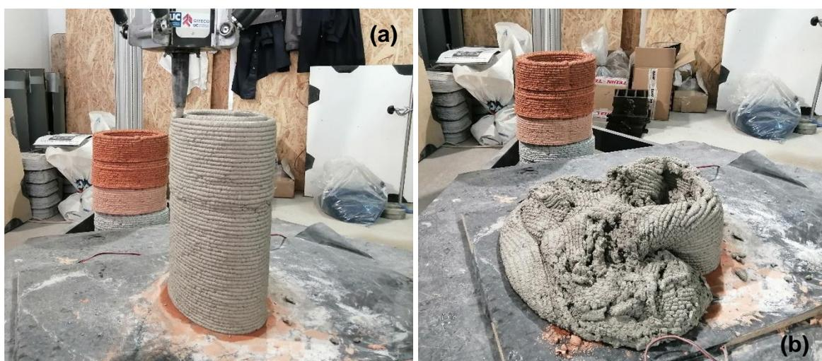
Figura 3-19. Prueba de edificabilidad en morteros.
