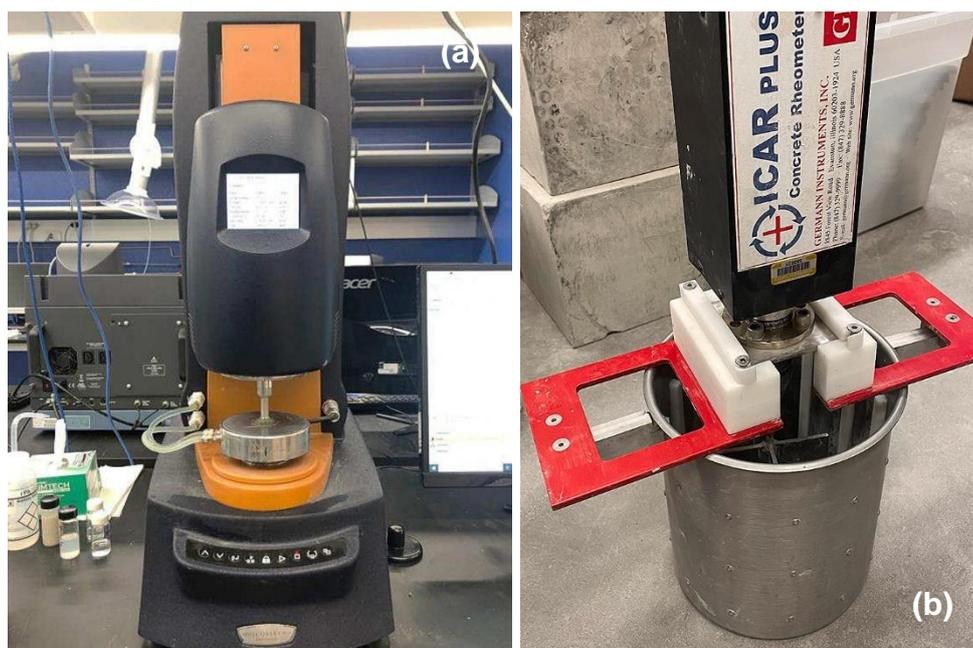
Figura 2-45. (a) Reómetro oscilatorio. Fuente: [80]. (b) Reómetro rotacional. Fuente: [67].
