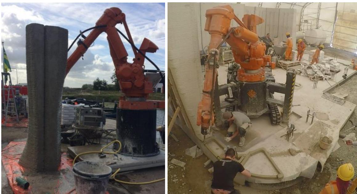
Figura 2-15. Impresora de brazo robótico fija y móvil respectivamente. Fuente: [CyBe](#).
