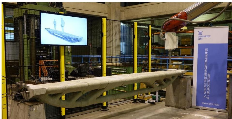
Figura 2-58. Viga diseñada con optimización topológica e impresa en 3D. Fuente: [152].
