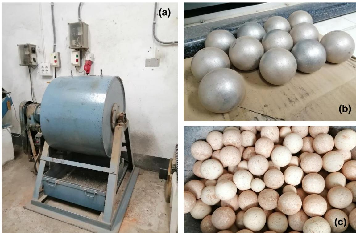
Figura 3-2. (a) Equipo de Los Ángeles. (b) Bolas de acero. (c) Bolas de alúmina.
