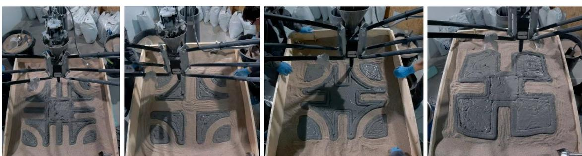
Figura 3-24. Impresión de ARs. Secuencia correspondiente con las filas de agujeros.
