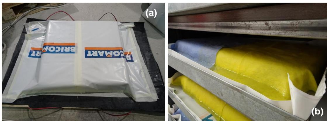
Figura 3-10. Curado de las placas de comparación una vez impresas.
