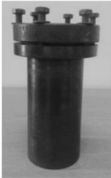
Figura 4.3. Reactor de síntesis de las zeolitas
