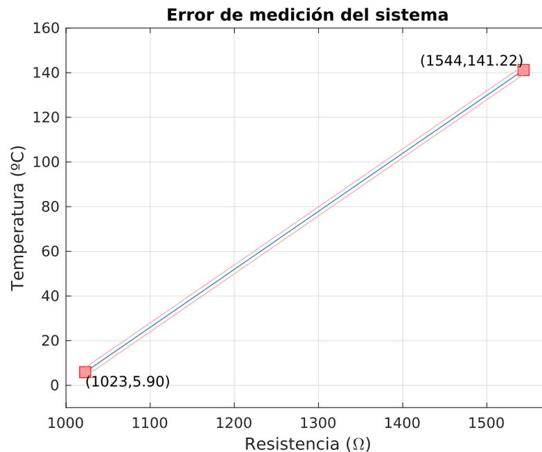
Figura 2.11: Error de medición introducido por el sistema.
